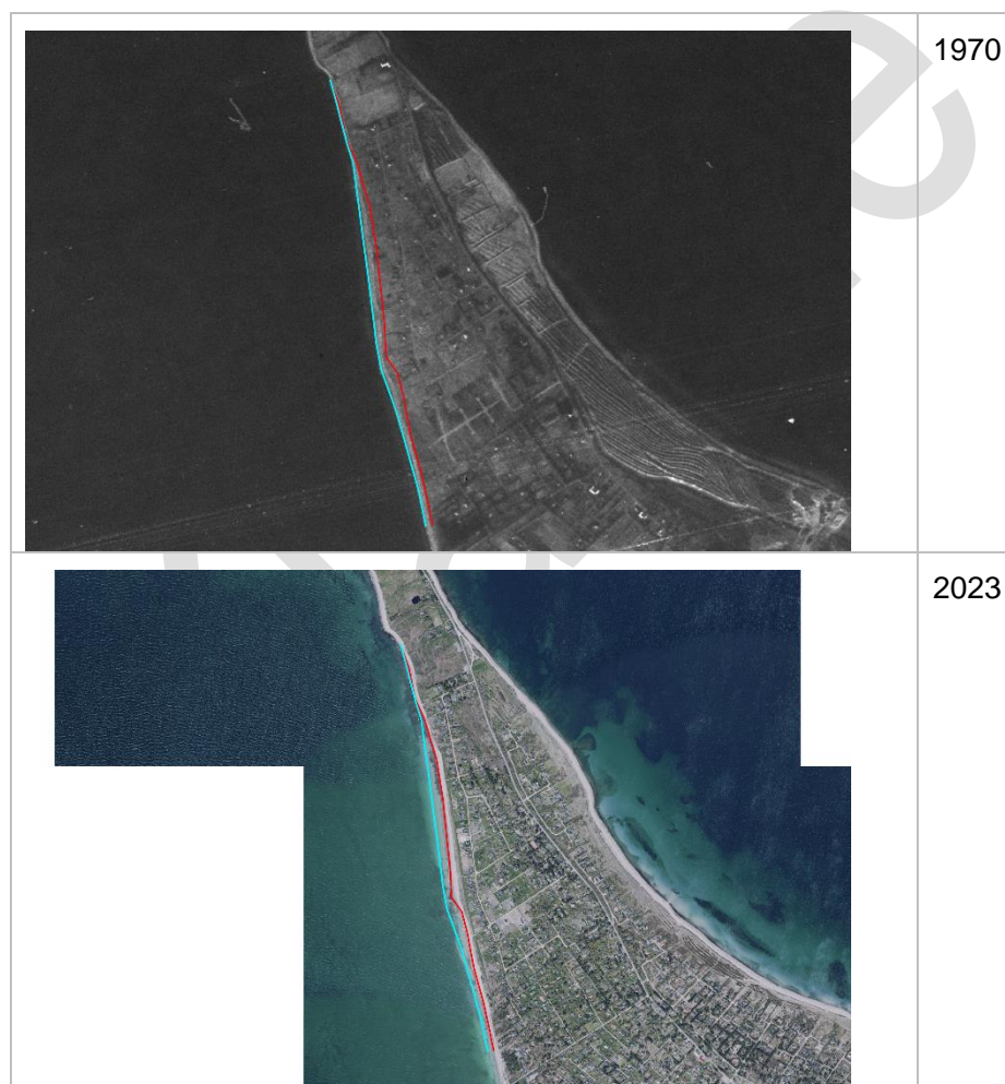
Figur 1 Kystlinjer 1970 (turkis) hhv. 2023 (rød). Øverst: Kystlinjerne plottet over 1970 ortofoto. Nederst: Kystlinjerne plottet over 2023 ortofoto.
